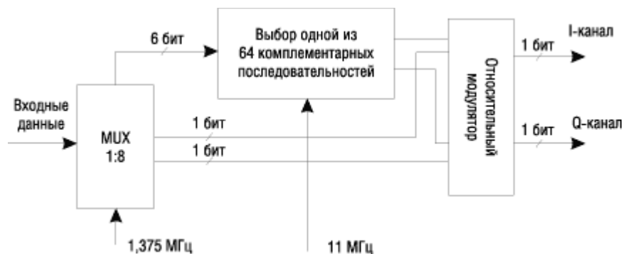
Рис. 13. Блок-схема ССК-модулятора.
